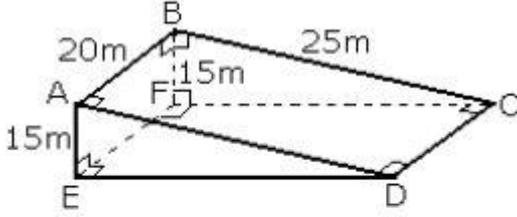
Şekilde görülen ABCD dikdörtgeni biçimindeki meyilli arsa, toprak kazılarak yatay bir CDEF dikdörtgeni biçimine getiriliyor.
